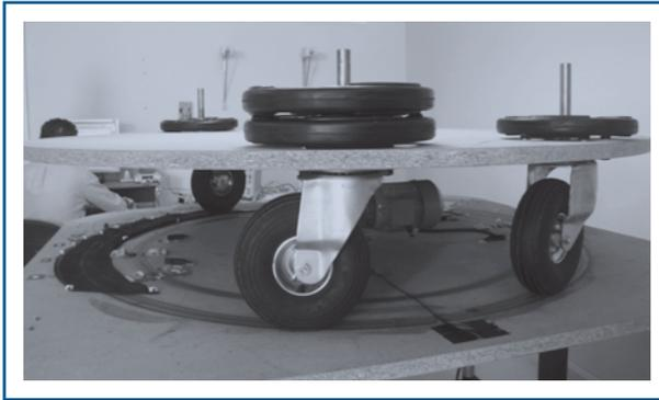
Figura 24.- Prototipo de Anillo para verificar la influencia de la velocidad sobre la respuesta del piezoeléctrico.
