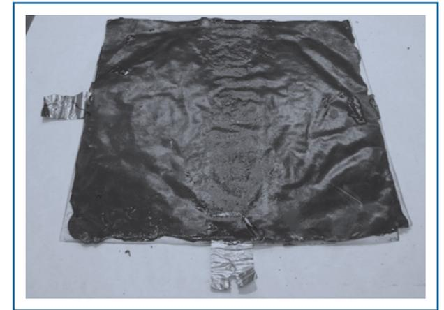
Figura 13.- Lámina de betún con piezoeléctricos embebidos.
