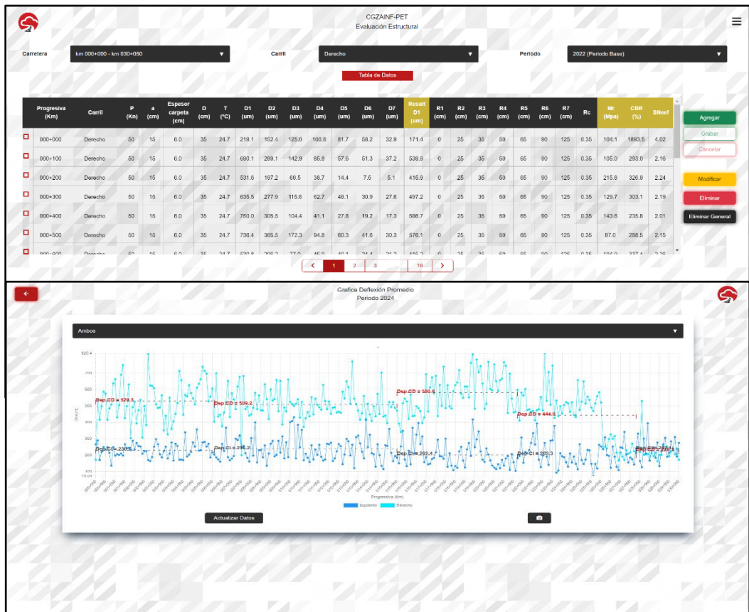
Figura 30 - Interfaz y Gráfica de Evaluación Estructural en el EvalPav Network
