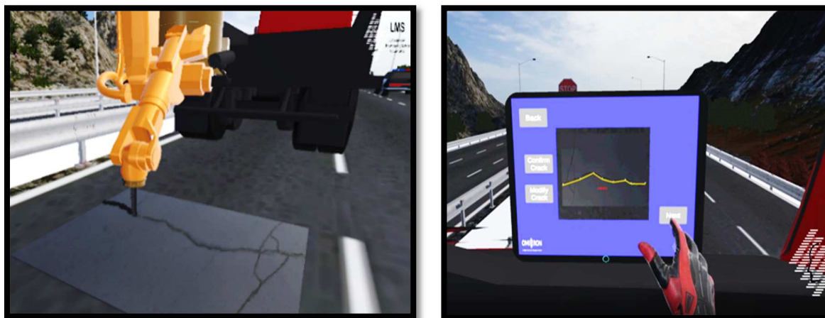
FIGURA 6. Imágenes de VR del proceso de sellado de grietas para entrenamiento.
