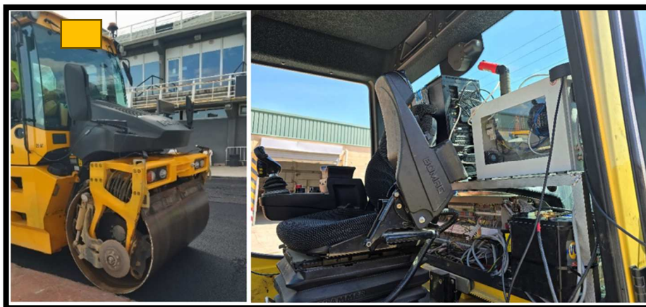
FIGURA 31 :Sistema de adquisición montado en máquina móvil.
