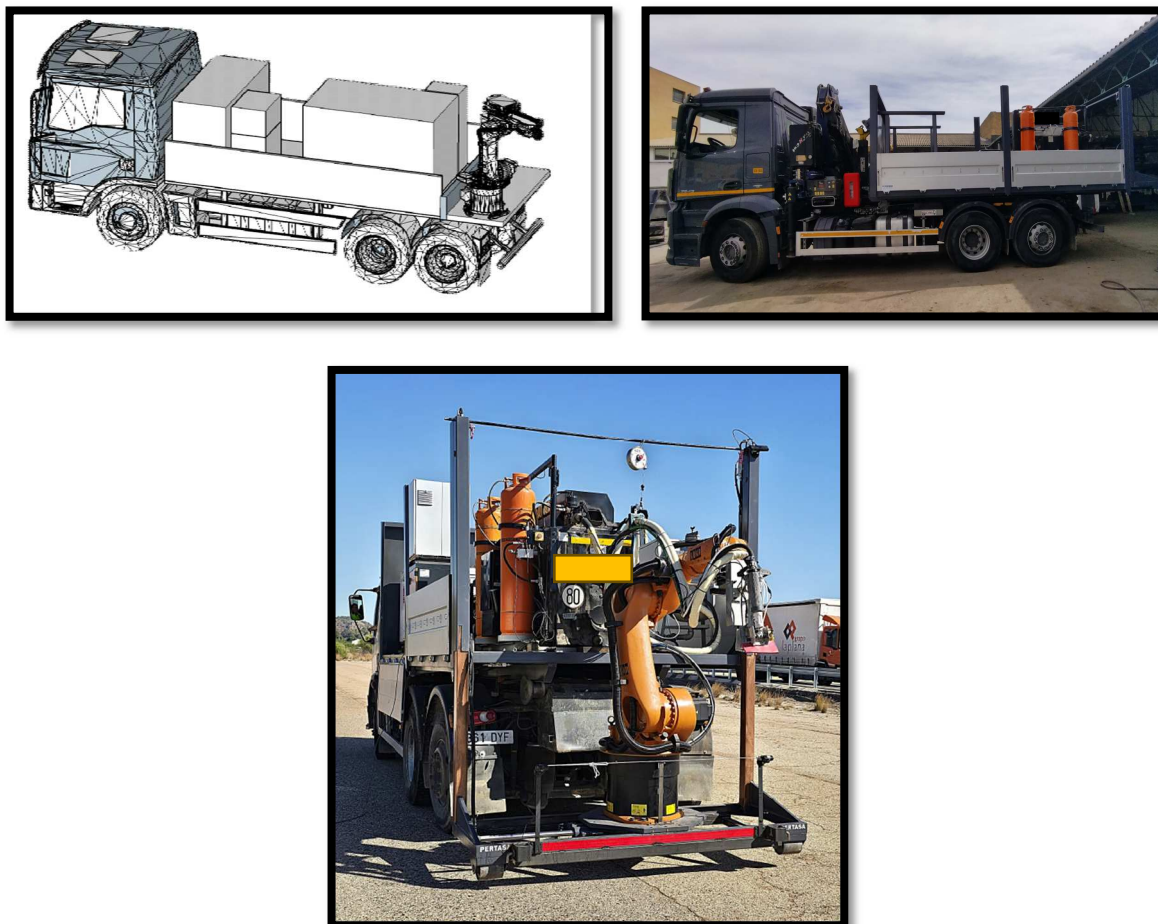
FIGURA 5. Modelo conceptual y fabricación de la plataforma robótica multifunción polivalente.
