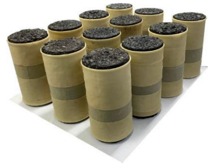
Figura 29 – Almacenamiento de las probetas de CRM en condiciones de sellado parcial
