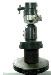
Figura 11 – Rotura según ensayo inmersión compresión
