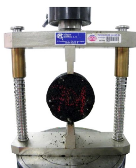
Figura 12 – Rotura según ensayo ITS
