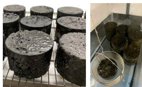
Figura 15 – Probetas impermeabilizadas con parafina, y peso sumergido
