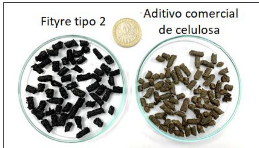
Figura 9. Imagen comparativa entre el aditivo Fityre tipo 2 y el aditivo comercial de celulosa para mezclas SMA.
