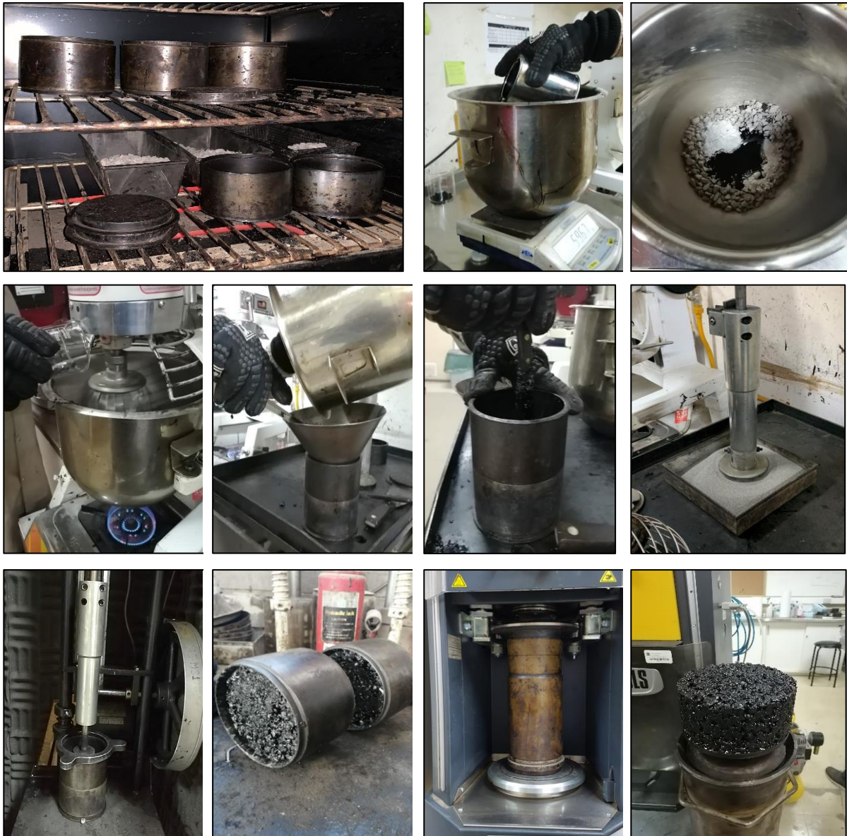
Figura 10. Imágenes de fabricación de probetas de mezclas asfálticas tipo SMA.
