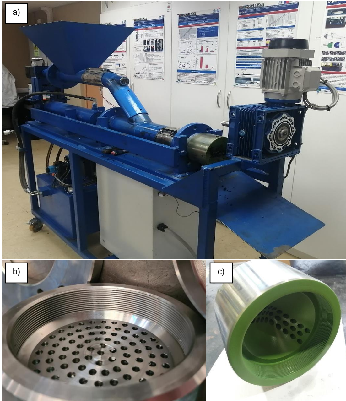
Figura 16. (a) Equipo extrusor 3; (b) Disco de extrusión plano de 5,5 mm de diámetro de salida; y (c) Disco de extrusión cónico de 3,5 mm de diámetro de salida.
